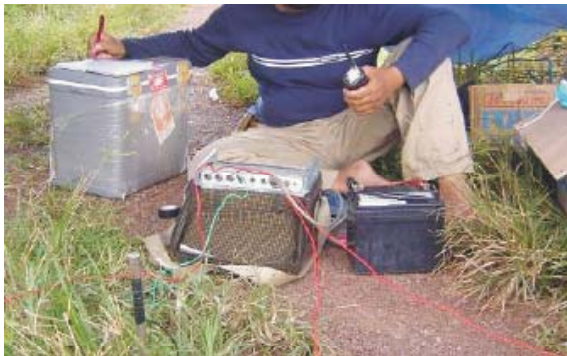
Gambar 7. Pengukuran dan pencatatan nilai-nilai tahanan jenis di lapangan
